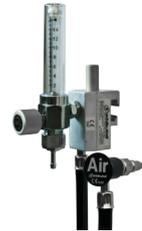
**22801bD**      **Luftentnahmearmatur FM, mit Schlauchtülle 6 mm und Universalhalter** fertig konfektioniert mit 1.5 m Schlauch schwarz-weiss und Stecknippel Air DIN, abgewinkelt
