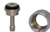
**22422a** Schlauchtülle 8mm - Set bestehend aus: Überwurfmutter G 1/2", O-Ring und 8mm Schlauchtülle
