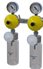
**8303e** **Doppel-Vakuumregler 0 bis -1000 mbar, Sicherheitsflasche 300ccm mit**
