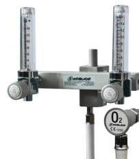
**22410D** Doppel-O2 Spender mit Universalhalter, Sterilwasseranschluss, fertig konfektioniert mit 1,5m Schlauch weiss und Stecknippel O2 abewinkelt (DIN)
