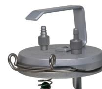
**8071c15b** Schnellverschlussdeckel (15 mm) komplett mit Traggriff
